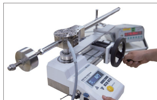
トルクレンチテスタ DOTE4 における JCSS 校正の例
