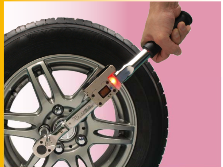
LED leuchtet beim 2. Anzug einer bereits mit dem erforderlichen Drehmoment angezogenen Schraube rot.
