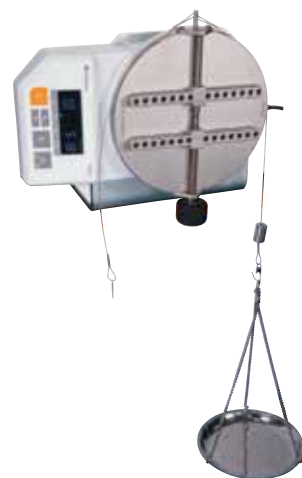
Abbildung des Kalibrierkits TMTCL2 mit TME3-G
