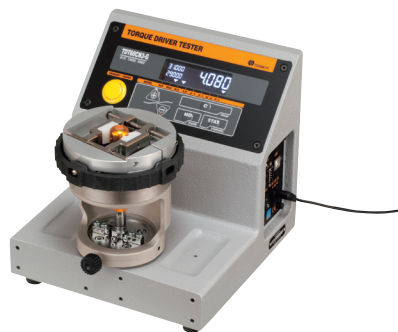
Abbildung 7-4. Drehmomentschraubendreher-Prüfgerät mit eingelegtem Drehmomentschraubendreher.
